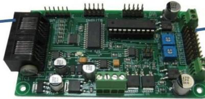
Contrôleur de servomoteur convertit les données à une sortie pour commander le servo
